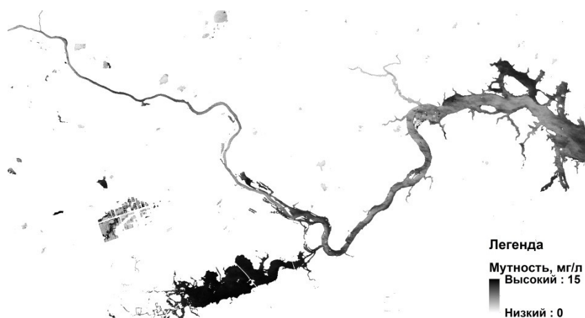
Р и с . 3. Растр полученных значений показателя мутности воды Иваньковского водохранилища, по снимку Landsat-8 (4 июля 2015 г.)
