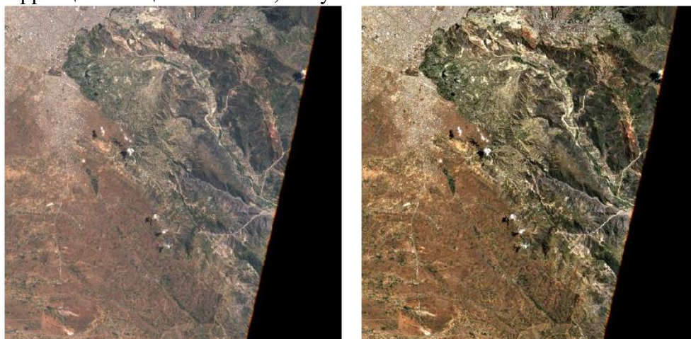
Р и с. 15. Слева – входной продукт L1C в видимом диапазоне; справа – выходной продукт – композиция 2-4 каналов, RGB.
